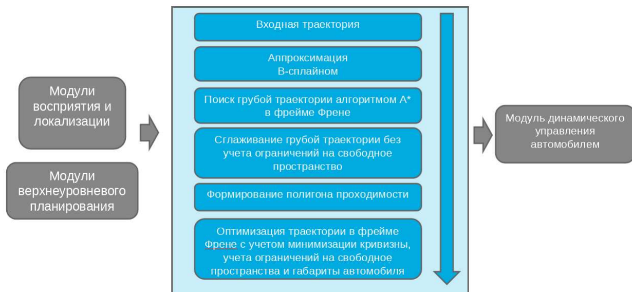
Рисунок 18 – Блок-схема алгоритма генерации локальной траектории движения автомобиля с учетом дорожных ограничений по маршруту движения представлена
