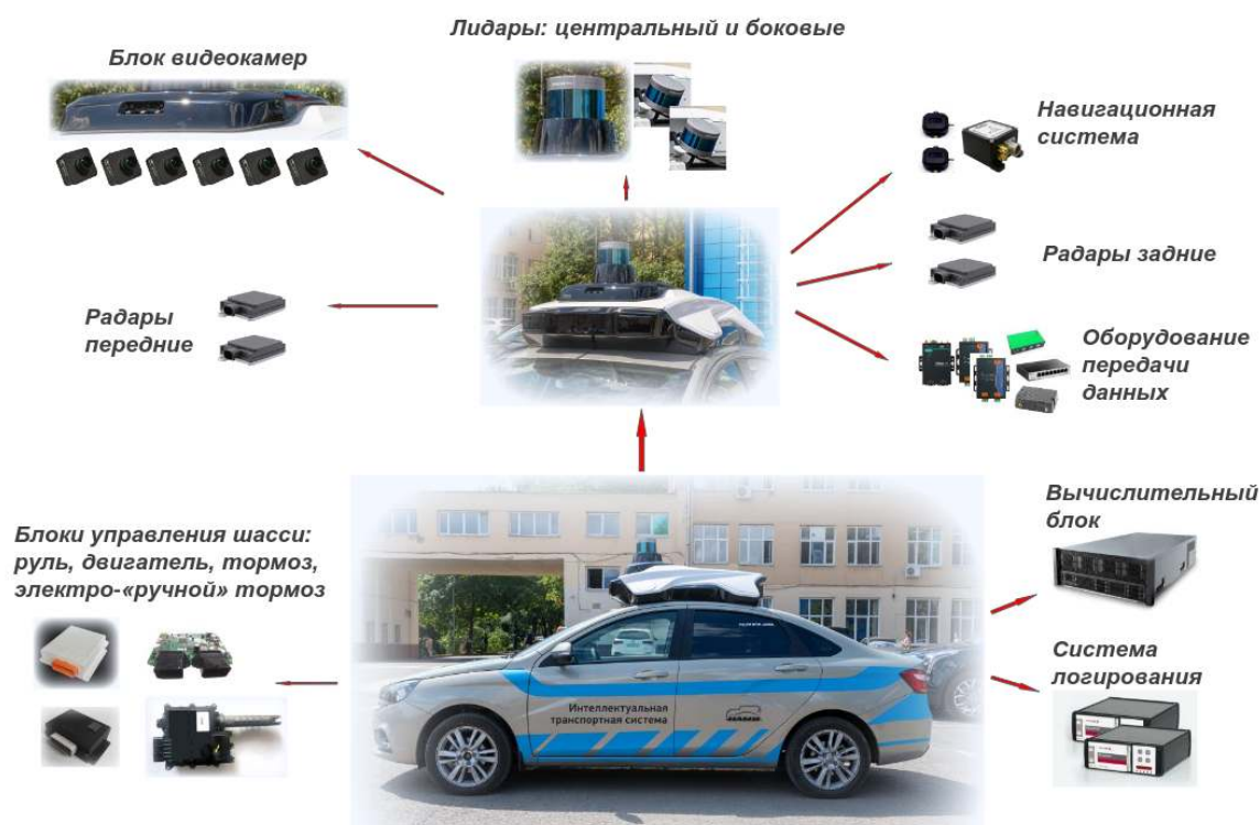
Рисунок 38 – Беспилотный автомобиль Lada Vesta с установленной системой автономного управления движением
